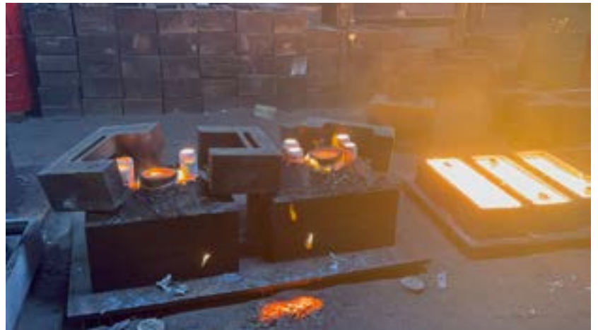
Appendix 5F Design A mold cooling after direct pour
