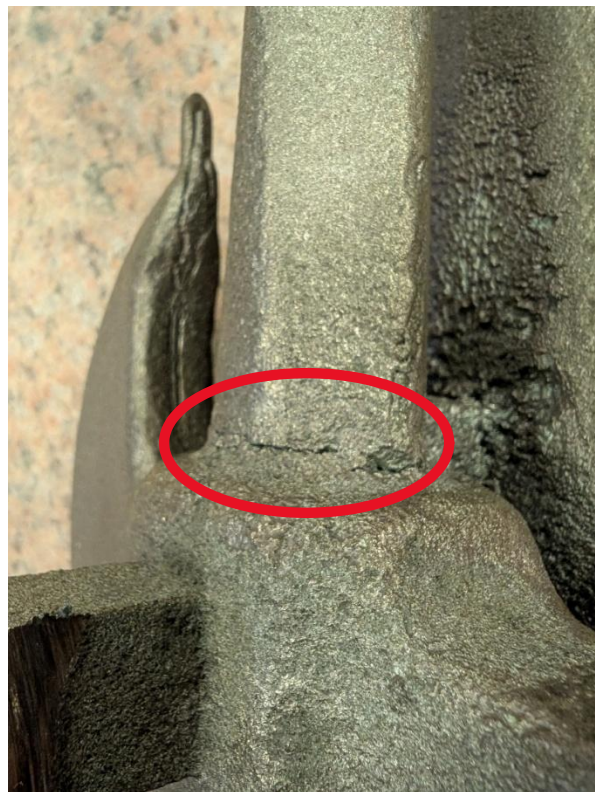
Figure 16. Hot tearing on test pour of Mold 1.6.
